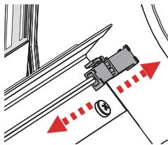
**B** Retire los tornillos de los soportes.
