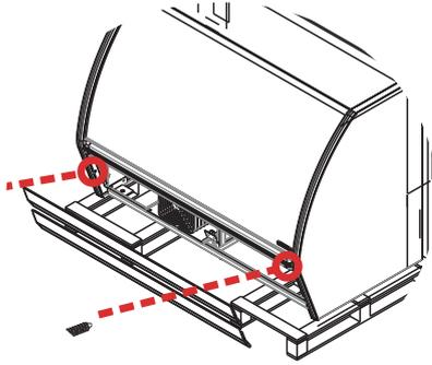
**B** Para darle mantenimiento y/o limpieza al condensador use aire a presión.
