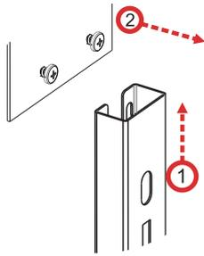
1. Para remover las cremalleras solo debe deslizarlas hacia arriba para levantarlas.
