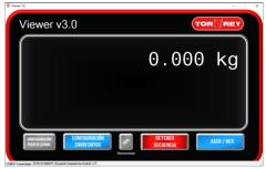
Seleccione "Conectar" y después "Empezar Secuencia", inmediatamente podrá observar en pantalla el peso que coloque en su báscula en tiempo real. Para finalizar la transmisión de datos presione "Detener Secuencia" y después el ícono "Desconectar".
