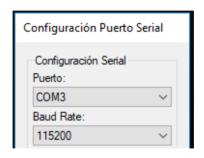
Seleccione "Configuración de Puerto Serial", elija la velocidad de transmisión y recepción (115200 bps recomendado), y el puerto al que se conectó la báscula.
