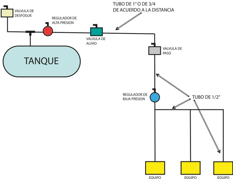
**NOTA:** Antes de conectar el regulador, verifique la presión de la línea que viene. El regulador solo puede soportar una presión máxima de 1/2 PSI (14" WC). Si la presión de la línea de llegada a la entrada del regulador proporcionado es mas alta de 1/2 psi es indispensable, anteponer un regulador con una salida controlada de 1/2 psi. La flecha en la parte inferior muestra la dirección del flujo de gas y debe apuntar en dirección hacia el equipo.
