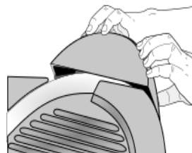
FIG 3. INSTALACIÓN DE AFILADOR
